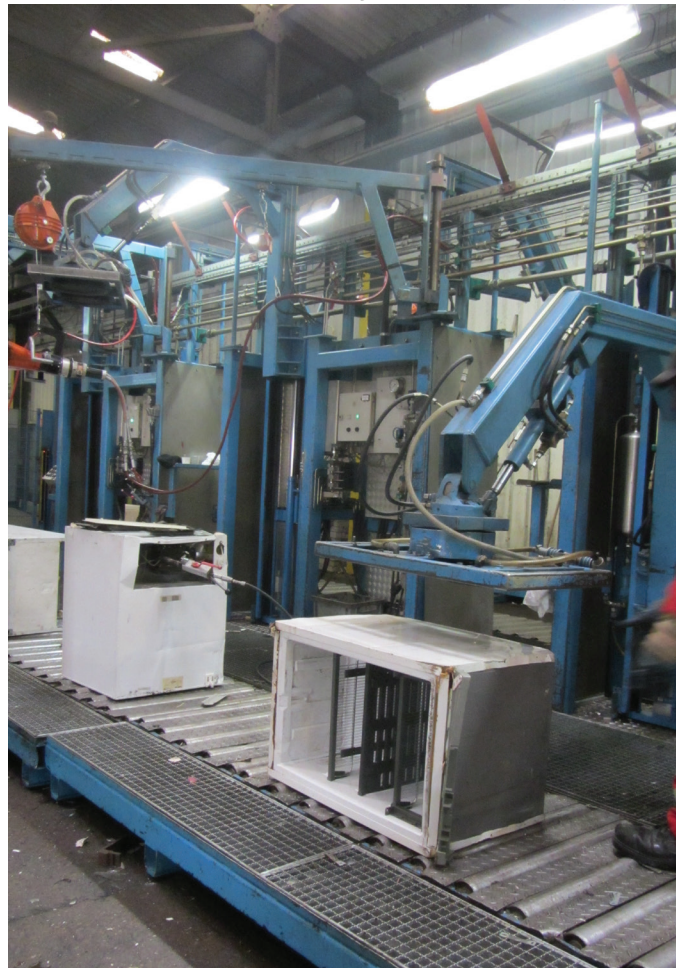
Photo 1 : Pompage des fluides frigorigènes (Source : COREPA, Bruyères-sur-Oise (95))
